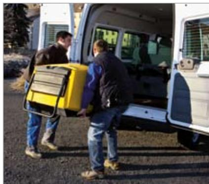
Les plus petits compresseurs MOBILAIR alimentent les bèches, marteaux, perceuses, scies, tournevis et ponceuses pneumatiques ou les fusées souterraines en air comprimé. La version à 15 bar convient particulièrement pour la pose en souterrain de câbles en fibres de verre pour les tests d'étanchéité. Un refroidisseur final d'air comprimé permettant d'obtenir de l'air comprimé frais, exempt de condensat, est proposé en option.
