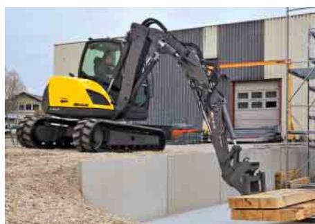
**Manutention avec fourches, unique sur une pelle: la dépose en négatif.**
