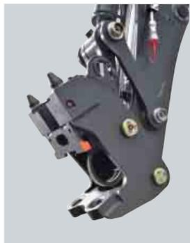
Grâce à l'attache rapide **ACTIVE LOCK**, le changement d'accessoires (godets rétro, curage, chargeurs, fourches, platines de manutention, etc.) s'opère en quelques secondes à peine.
