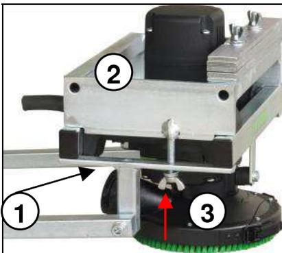
Placez ensuite le dispositif avec le support ① sous la poignée de châssis et fixez-le avec un disque, un anneau élastique et l'écrou papillon ③ sur le châssis supérieur ②.
