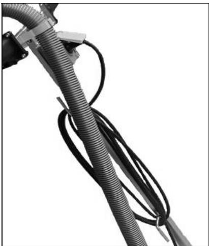
Enroulez le cordon de l'outil sur le support destiné à cet effet. **Assurez-vous que l'interrupteur du dispositif de guidage au sol n'est pas enclenché ou verrouillé.** Branchez la ponceuse dans la prise du dispositif de guidage au sol. Amenez le flexible de l'aspirateur au dessus du dispositif de guidage au sol et branchez-le à la ponceuse. La pince empêchera que le flexible ne glisse.
