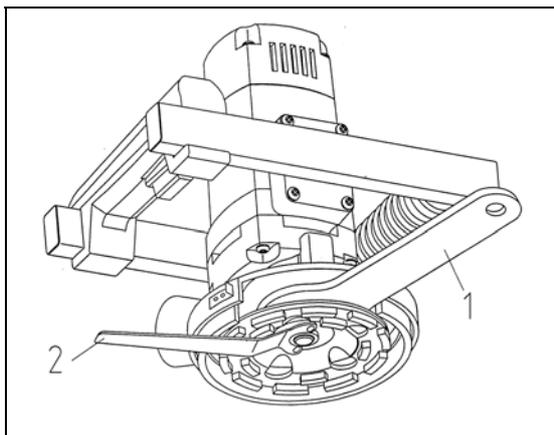
Il faut commencer par déposer la partie démontable du capot anti-poussière. Ouvrir le verrou et dégager la partie démontable du capot anti-poussière. On peut ensuite verrouiller le disque d'entraînement entre la machine et le disque à l'aide de la clé de 32 (1). Desserrer l'écrou de sécurité à l'aide de la clé à pans (2). Enlever ensuite le disque et le remplacer par un nouveau. Pour le remontage, procéder en ordre inverse.
