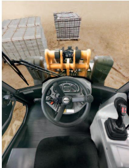
Le mono-boom et le capot moteur court permettent une visibilité optimale
