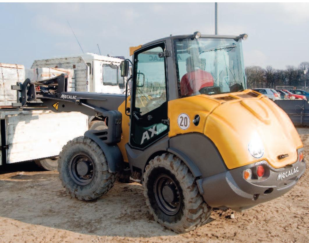
**Le bras mono-boom** de l'AX apporte une force d'arrachement élevée. La cinématique en Z permet un levage parallèle performant et le chargement de palettes en toute sécurité. Des cycles de travail courts et une excellente visibilité sur les accessoires rendent le travail plus productif.
